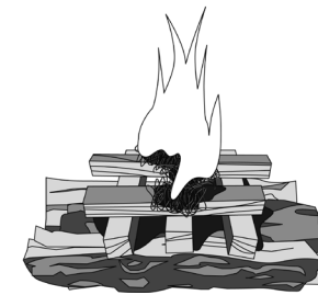
AFB. 4.7 Brandende aansteekmodule op de stapel met brandhout
